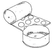
**J.** El aluminio fundido es casi siempre una aleación (se mezcla con otros metales y elementos para hacerlo más fuerte). Entonces se vacía en moldes para formar los lingotes. Estos pueden ser varillas largas, trozos grandes que pesan más de 20 toneladas (18,144 kg.) o en pequeños ladrillos que sólo pesan 4 libras (1.8 kg.)
